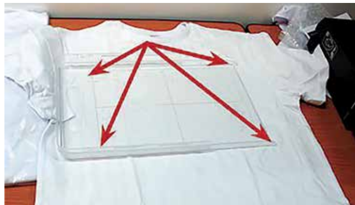
Малюнок 5. Через отвори на кришці лотку для друку на футболку можна нанести мітки спеціальною ручкою, щоб точно розташувати виріб на робочому столі
