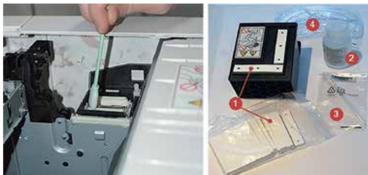
Малюнок 6. Принтер «сам просить» почистити «капи» – це робиться вручну за допомогою ватних паличок (фото зліва). Інші витратні матеріали: очищувальні смужки для друкувальних голівок (1), очищувальна рідина (2), яку наносять на ці смужки, піпетка (3) для рідини, захисні окуляри (4).
