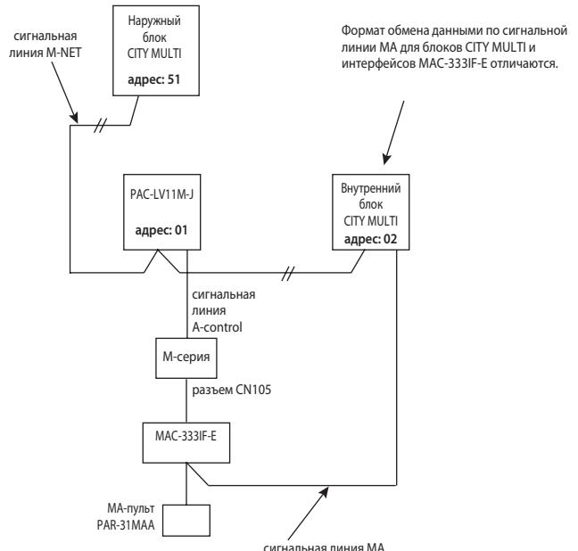
Контроллер фреоновых секций приточных установок
