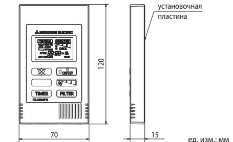
Проводной пульт для автономного управления одной или группой (не более 15) установок Lossnay.
