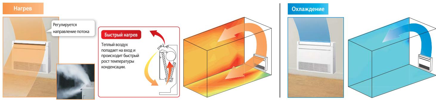
В режиме охлаждения воздушный поток тоже может быть направлен одновременно вверх и вниз.
