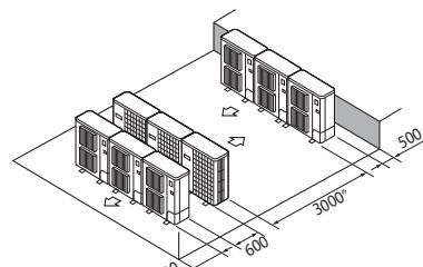
Параллельное расположение нескольких блоков
