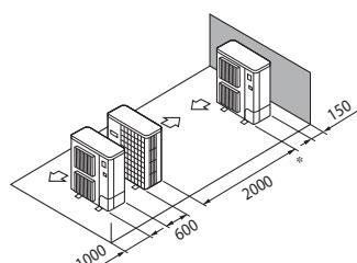
Параллельное расположение 2-х блоков
