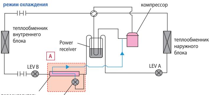
Переохладитель добавлен в гидравлический контур для увеличения энергоэффективности системы в режиме охлаждения. Часть жидкого хладагента испаряется в переохладителе и поступает на вход компрессора, увеличивая давление в линии всасывания. Нагрузка компрессора уменьшается, а энергоэффективность системы увеличивается.
