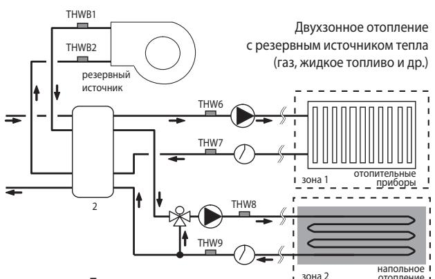
**Примечание.** Режим охлаждения не может быть включен в режиме двухзонного управления. Допускается одновременное охлаждение зон 1 и 2.
