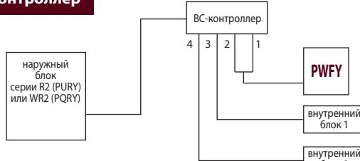
Существуют модификации BC-контроллеров с разным количеством портов (штуцеров для подключения внутренних блоков). Выбор модификации осуществляется, исходя из количества помещений, в которых нужно обеспечивать охлаждение и обогрев независимо. Также следует принимать во внимание суммарную производительность внутренних блоков.
