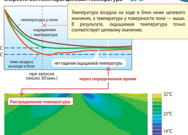
Система учитывает температуру воздуха у пола, поэтому ощущаемая температура стабильно держится на уровне 28°C. Кроме того для создания такого эффекта мощность охлаждения уменьшается через определенное время. Это приводит к существенной экономии электроэнергии.
