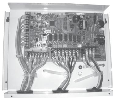
Контроллер PAC-IF012B-E предназначен для плавного (ступенчатого) управления наружными блоками полупромышленной серии Mr. Slim:
