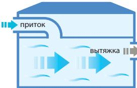
Организация циркуляции воздуха с помощью приточно-вытяжной системы обеспечивает сбалансированный воздухообмен в помещении и эффективное удаление загрязненного воздуха.
