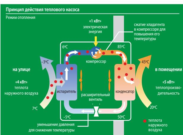
воздушный теплообменник на улице). При низком давлении жидкость испаряется (превращается в газ) при температуре ниже, чем температура наружного воздуха или грунта. В результате часть тепла наружного воздуха или грунта переходит во внутреннюю энергию хладагента. Газообразный хладагент вновь поступает в компрессор — контур замкнулся.
