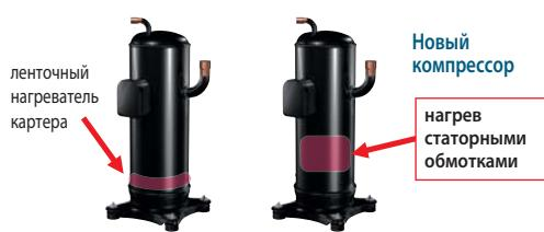
Подогрев компрессора в блоках CITY MULTI G6 осуществляется статорными обмотками электродвигателя. Это обеспечивает более эффективное использование электроэнергии в сравнении с внешним ленточным нагревателем картера компрессора.
