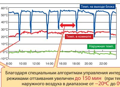
Пример эксплуатации наружного блока
