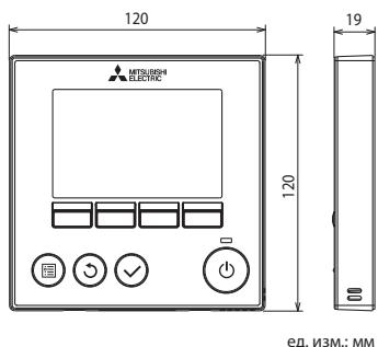
Проводной пульт для автономного управления одной или группой (не более 15) установок Lossnay.
