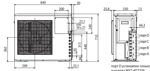
порт D установлен только в модели MXZ-4D72VA
