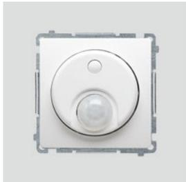
VMCR10P.01/.. Включатель с датчиком движения с реле (модуль) 8(2) А, 230 V~. **!**Требуется 3-проводной монтаж.
