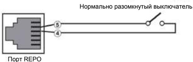
**Рисунок 7-4: Конфигурация порта REPO для нормально разомкнутого выключателя**
