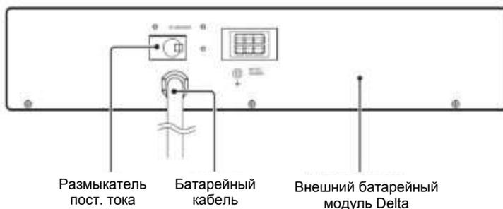
**Рисунок 4-1: Вид сзади внешнего батарейного модуля Delta**
